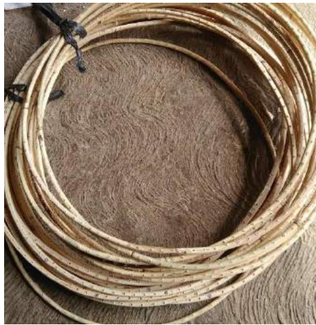
Gambar 18. Wengku sebagai kerangka atau tulang penguat yang ada pada Bagian Tengah Ruji (Dokumentasi: Sandi Rediansyah, 2020)
