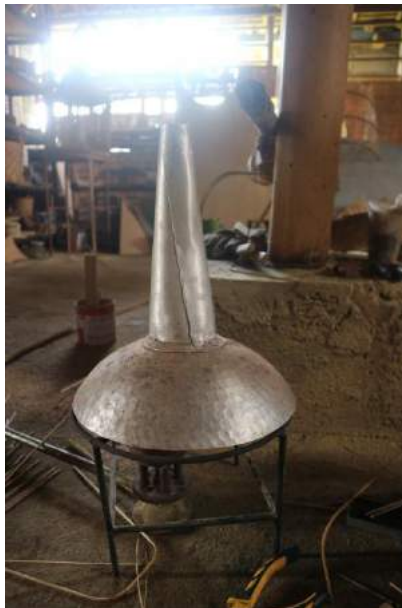
Gambar 16. Alat untuk memanaskan ruji/bahan bambu lainnya agar mudah dibentuk (Dokumentasi: Sandi Rediansyah, 2019)
