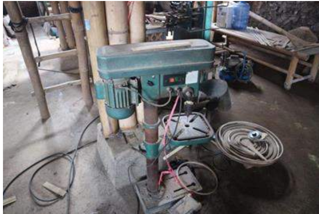
Gambar 19. Mesin Bor yang Digunakan untuk Melubangi Wengku (Dokumentasi: Sandi Rediansyah, 2019)
