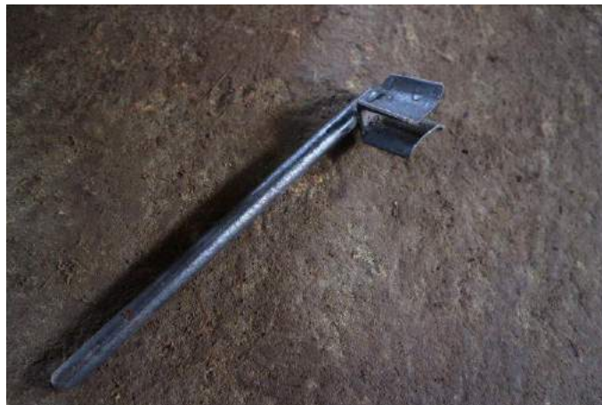
Gambar 21. Alat Bantu Membentuk dan Menyusun Lapisan Bambu (Dokumentasi: Sandi Rediansyah, 2019)
