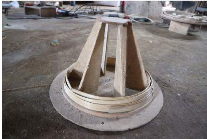
Gambar 20. Cetakan untuk Menyusun Lapisan Dasar Bambu (Dokumentasi: Sandi Rediansyah, 2019)
