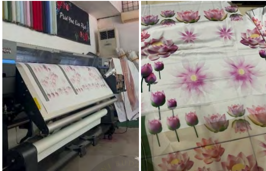
Gambar 3.16. Proses digital printing : (a) proses printing pada kain: (b) hasil kain yang sudah di printing (Sumber: Ayunia, 2025)
