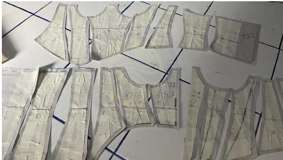
Gambar 3.20 Pola yang sudah dipotong sesuai dengan desain dan siap pakai (2) (Dokumentasi : Dani, 2024)
