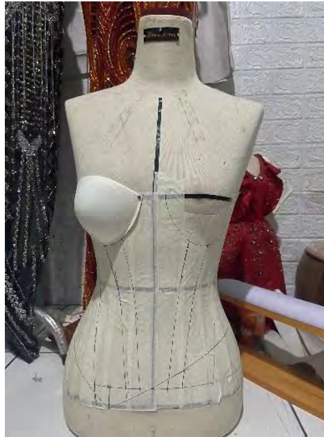
Gambar 3.18 Pembuatan pola dengan sistem drapping pada tubuh mannequin (Dokumentasi : Dani, 2024)
