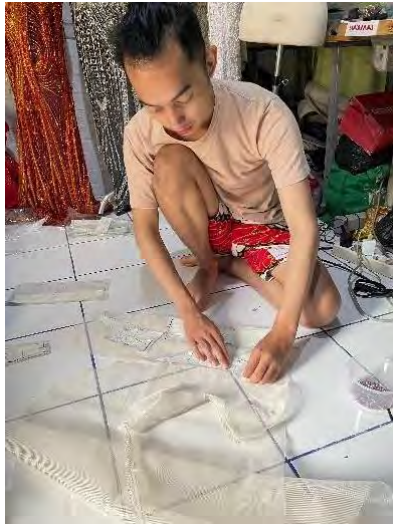
Gambar 3.22 Proses peletakan pola pada kain tille gazar (Dokumentasi : Dani, 2024)
