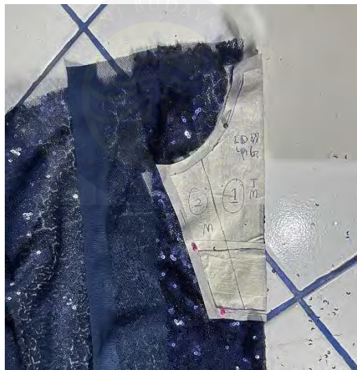
Gambar 3.23 Proses peletakan pola pada kain sequins (Dokumentasi : Dani, 2024)
