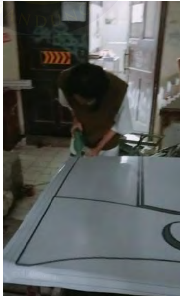
Gambar 2. 22 Proses pemotongan triplex
