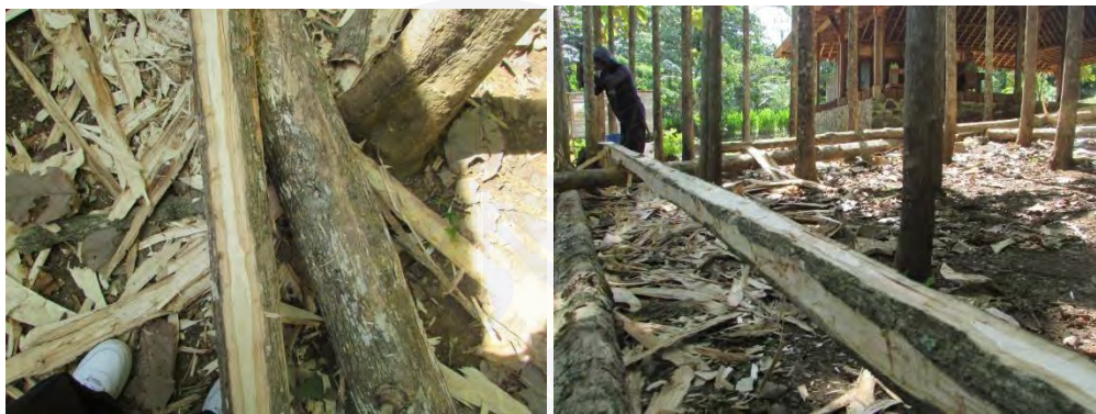
Gambar 6. 8. Perbandingan antara Kayu yang Belum dan Sudah Dipapas (Sumber; Dokumentasi pribadi 28 April 2025)
