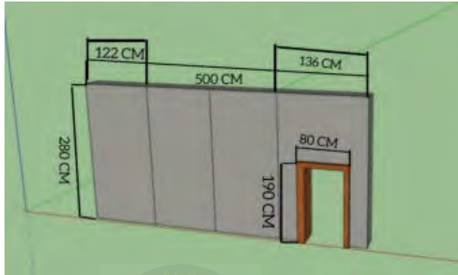
Gambar 69. Gambar ukuran dinding dan frame pintu belakang
