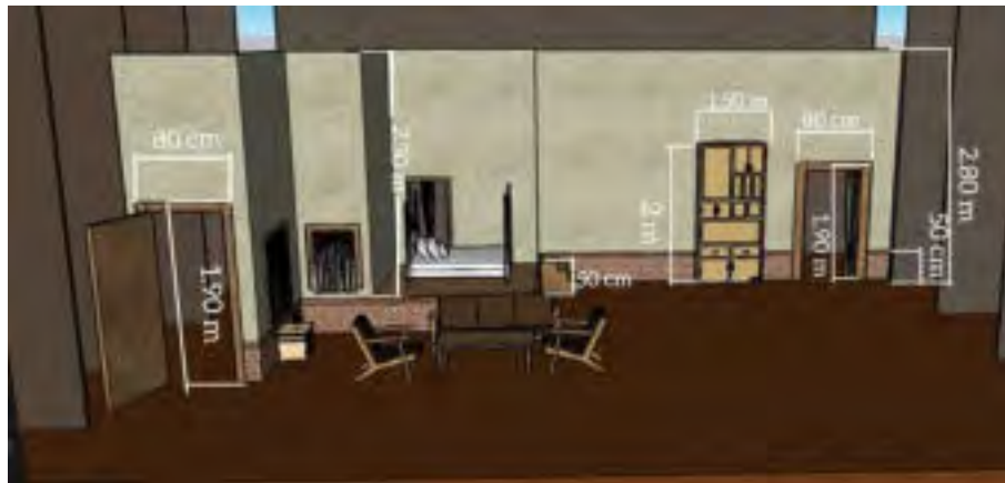
Gambar 58. Gambar ukuran setting dan properti tampak depan 1
