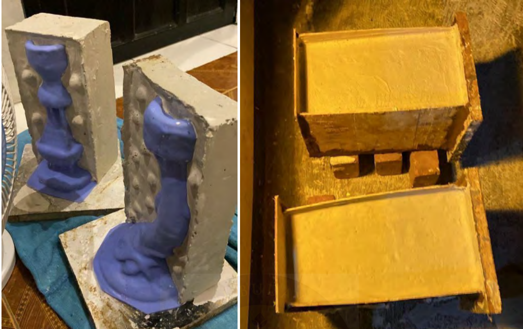
Gambar 2.43 Pengecoran gypsum bagian kedua
