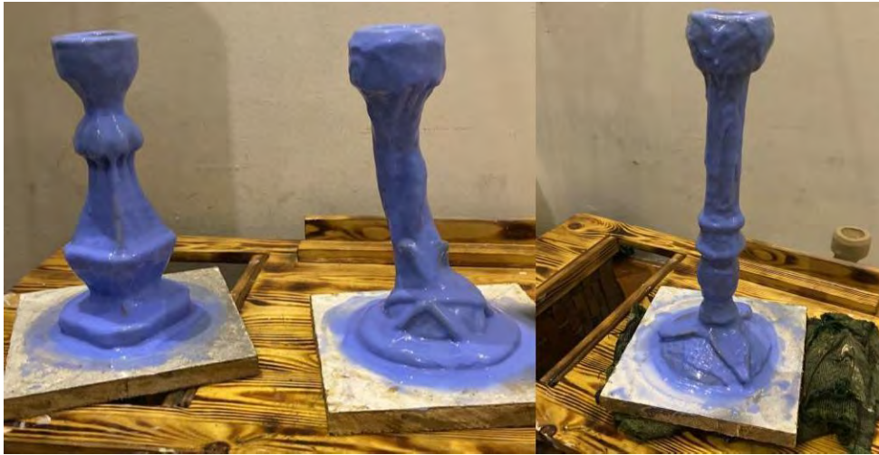
Gambar 2.39 Pelapisan modelling menggunakan silicon Rubber RTV-52
