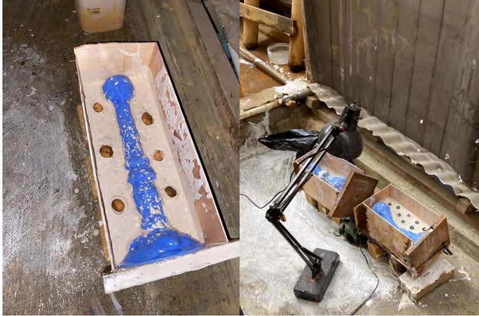
Gambar 2.41 Pengecoran gypsum dengan takaran 1 : 1
