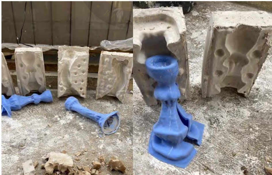
Gambar 2.44 Pembukaan coran gypsum
