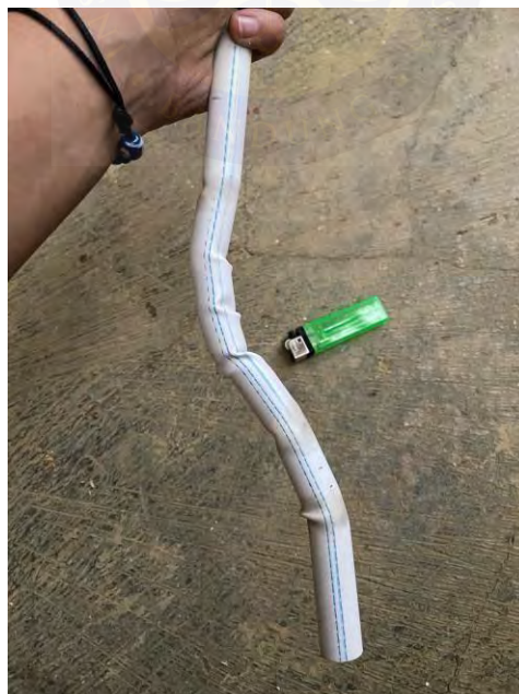
Gambar 2.33 Pelengkungan pipa untuk bagian tulang base
