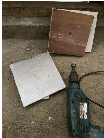
Gambar 2.31 Hasil pelubangan multiplek untuk bagian dasar base
