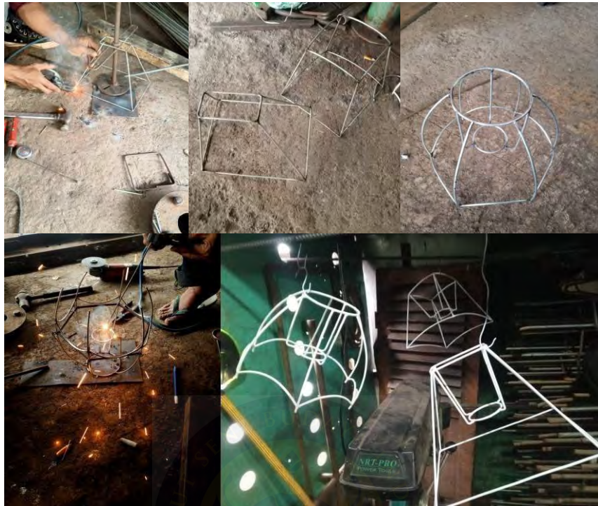
Gambar 2.37 Pegelasan desain kap lampu
