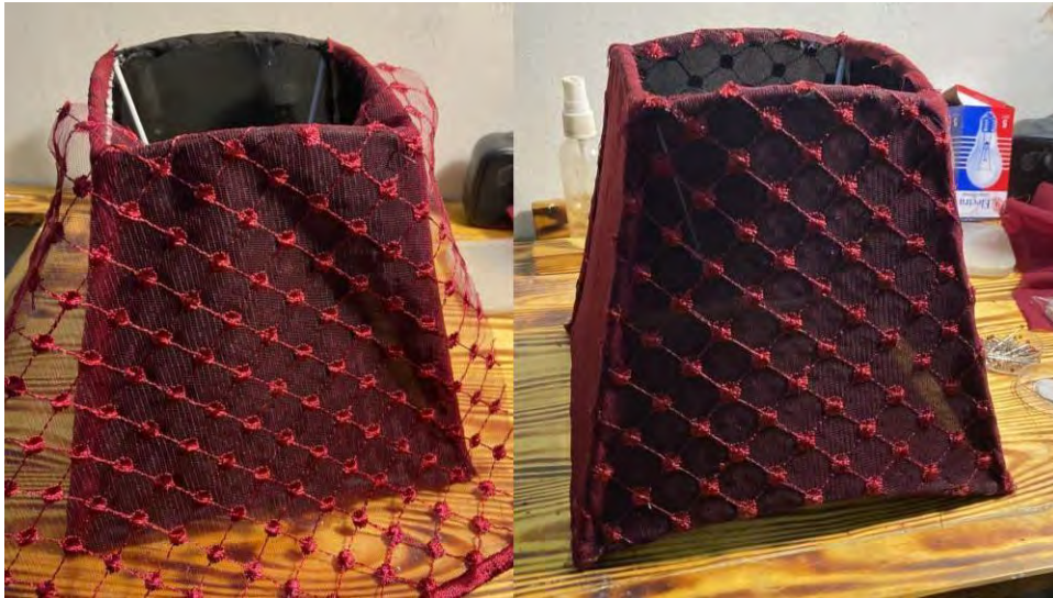
Gambar 2.49 penjahitan kain ke bagian rangka
