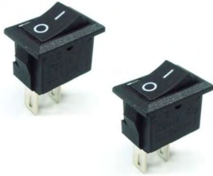
Gambar 2.10 Saklar switch, berfungsi untuk menyalakan lampu dan mematikan lampu.
