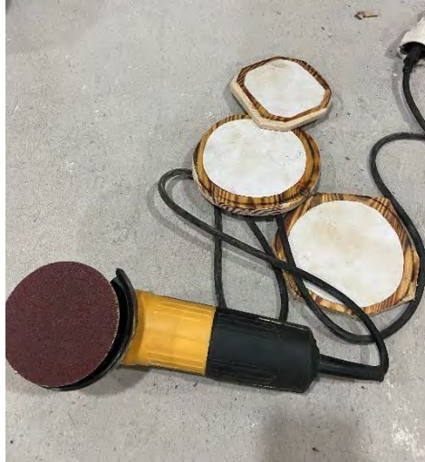
Gambar 2.55 pembuatan dudukan untuk saklar
