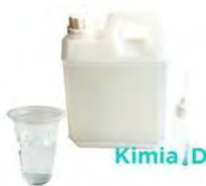
Gambar 2.7 Silikon , berfungsi untuk membuat cetakan bagian base dan batang.
